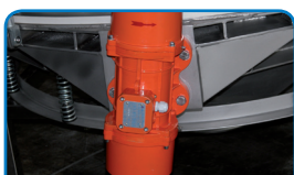
Antrieb über 2 Vibrationsmotoren (ATEX 22)
