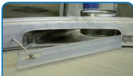
Réglage simple grâce à un déflecteur ajustable
