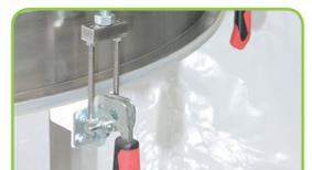
Assemblage des viroles par grenouillères pour un démontage et remplacement rapide des tamis
